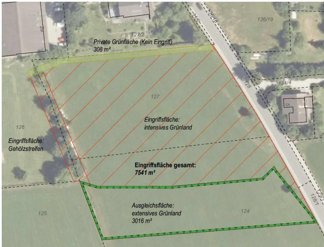
Abbildung 5 Luftbild Bestand mit nördlichem Pufferstreifen (hellgrün) Eingriffsbereich (rot) und Ausgleichsfläche (grün umrandet) (Abb. ohne Maßstab)
