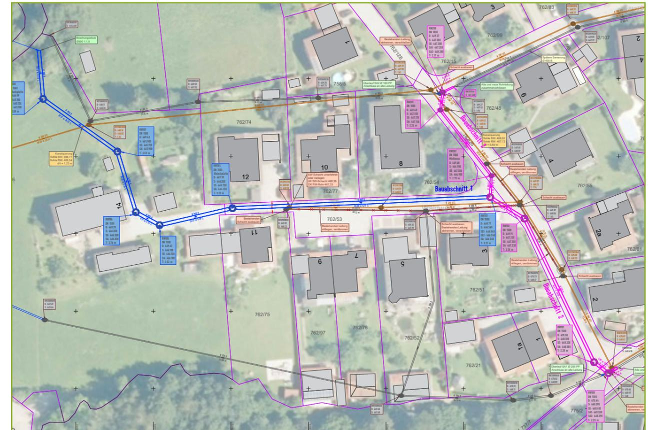
Vom Waldweg bis zum Röthbach wird eine neue Entwässerungsleitung verlegt. Dadurch wird die Abflussleistung erhöht und der Rückstau in den Rohren beseitigt. Den Überschwemmungen und überfluteten Kellern im Bereich des Waldweges kann dadurch vorgebeugt werden. Allerdings: Eine 100 %-ige Sicherheit wird man nie haben!
